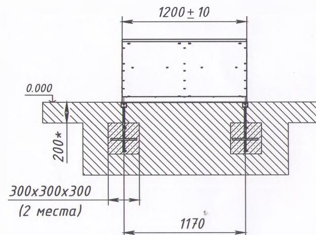
Нижняя перемычка на основании является базовой отметкой о заглублении оборудования и должны располагаться над поверхностью (покрытием) площадки.
